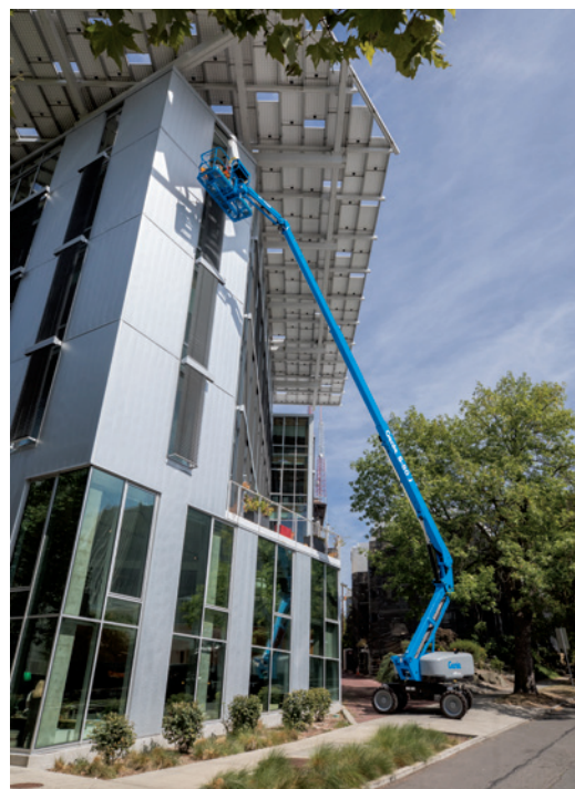
Korbarm mit 300kg Tragfähigkeit
